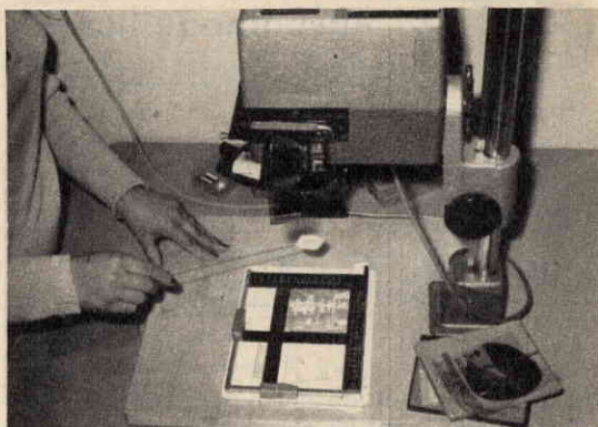
Fig. 13 - La figura illustra il modo con cui si procede per rischiarare un particolare per mezzo di un batuffolo di cotone.
