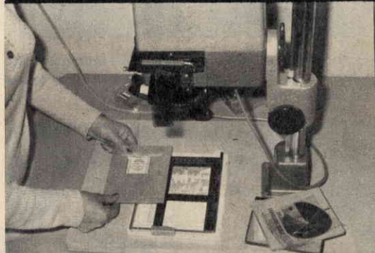
Fig. 9 a/b - Si esegue un provino del tempo di posa coprendo prima una parte e poi l'altra della carta sensibile durante l'esposizione.
